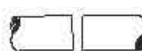
spojení oddělených trubek lehce prohlých nebo přesazených (max. 2°) (nutné: zavolejte nám prosím ohledně tohoto případu!)
